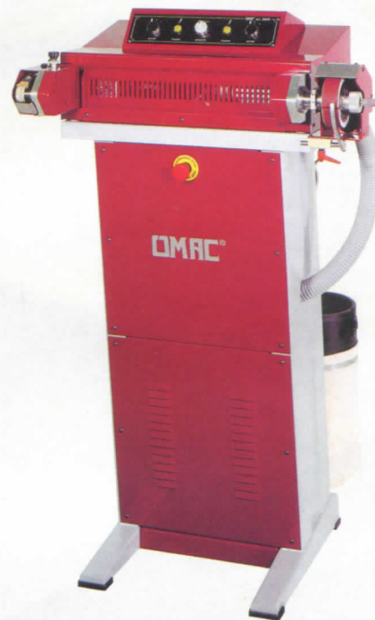
Máquina de redondear, pulir y pintar cantos de bolso al corte terminado. Modelo 360 V1-V2.
